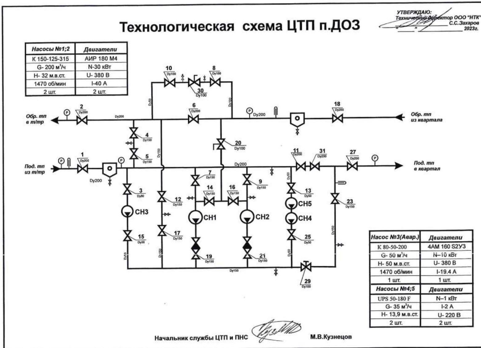
Рисунок 1.16 – Схема ЦТП п. ДОЗ (ЦТЭЦ)
