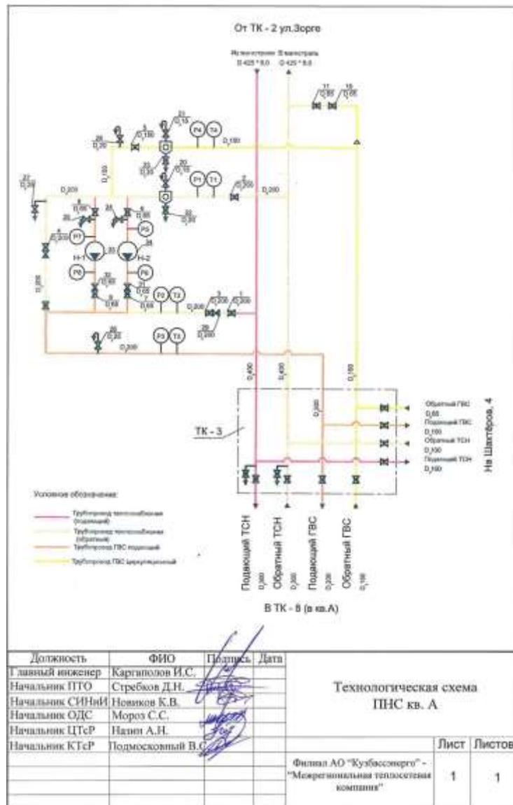
Рисунок 2.5 – Схема ПНС кв. А (КТЭЦ, АО «Кузбассэнерго»)
