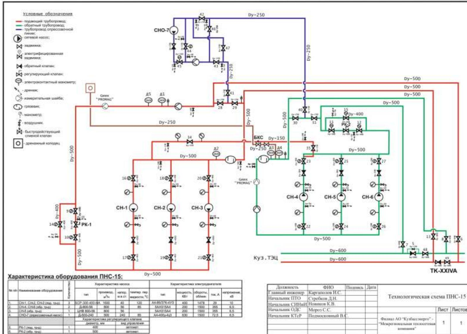
Рисунок 2.3 – Схема ПНС-15 (КТЭЦ, АО «Кузбассэнерго»)
