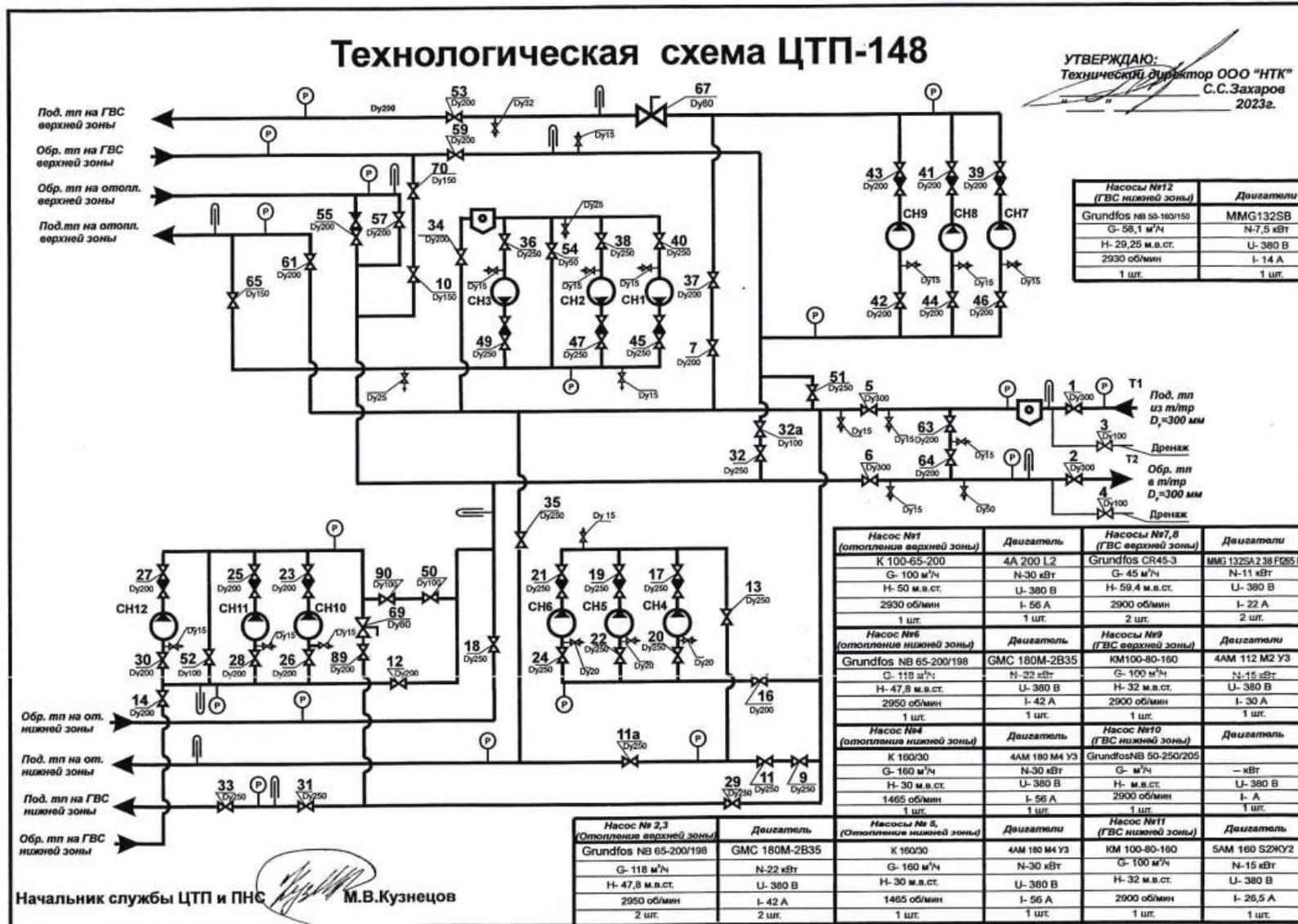
Рисунок 1.10 – Схема ЦТП-148 (ЗСТЭЦ)
